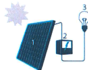
1. Zonnepaneel | 2. Omvormer | 3. Elektrische toestellen
