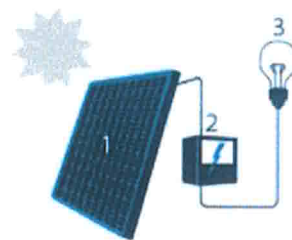
1 Zonnepaneel | 2. Omvormer | 3 Elektrische toestellen
