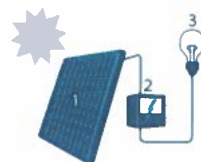
1. Zonnepaneel | 2. Omvormer | 3. Elektrische toestellen
