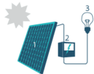
1. Zonnepaneel | 2. Omvormer | 3. Elektrische toestellen
